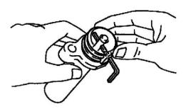
(d) Install the dust boot onto the tensioner.
