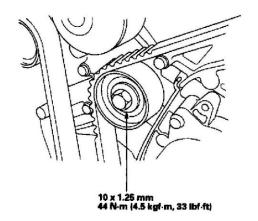
6. Tighten the idler pulley bolt.
