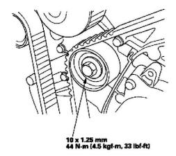
10. Tighten the idler pulley bolt.
